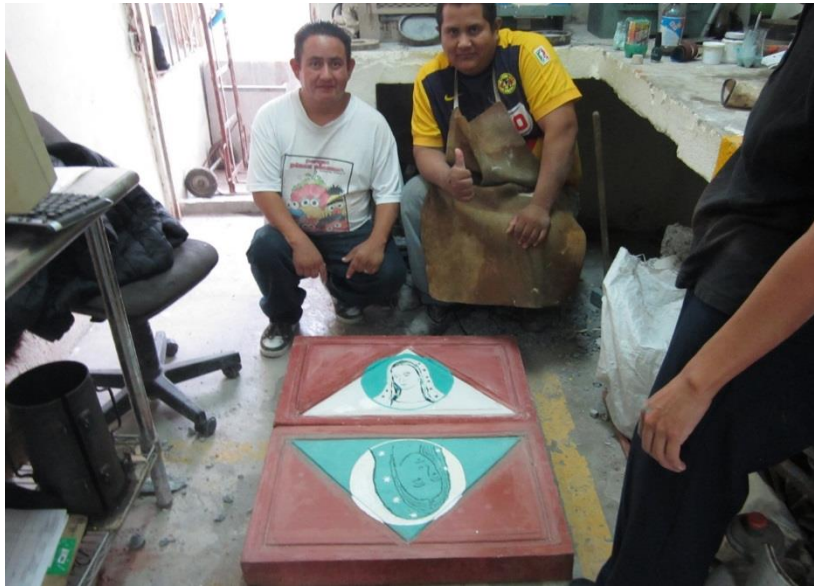
Fig. 16.- Banqueta hecha de 2 planchas de concreto con cementos ecológicos. Inspirada en bandera mexicana. Imágenes propias.
