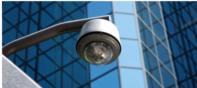
Figura No. 9: Cámara de Vigilancia CCTV.
